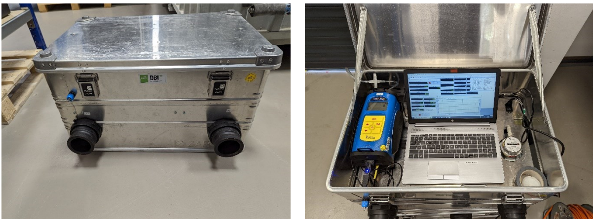
Abbildung 1: Ausrüstung zur Messung von Methanemissionsraten an Gas- Druckregel- und Messanlagen mit einem Raumvolumen von >17 \text{ m}^3 .
