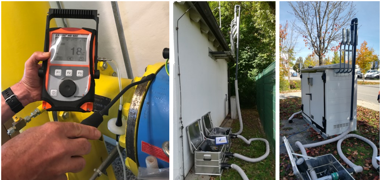
Abbildung 4: Beispiele der Source-Level-Messung (links) und der Site-Level-Messung (Mitte und rechts) Standortebene).
