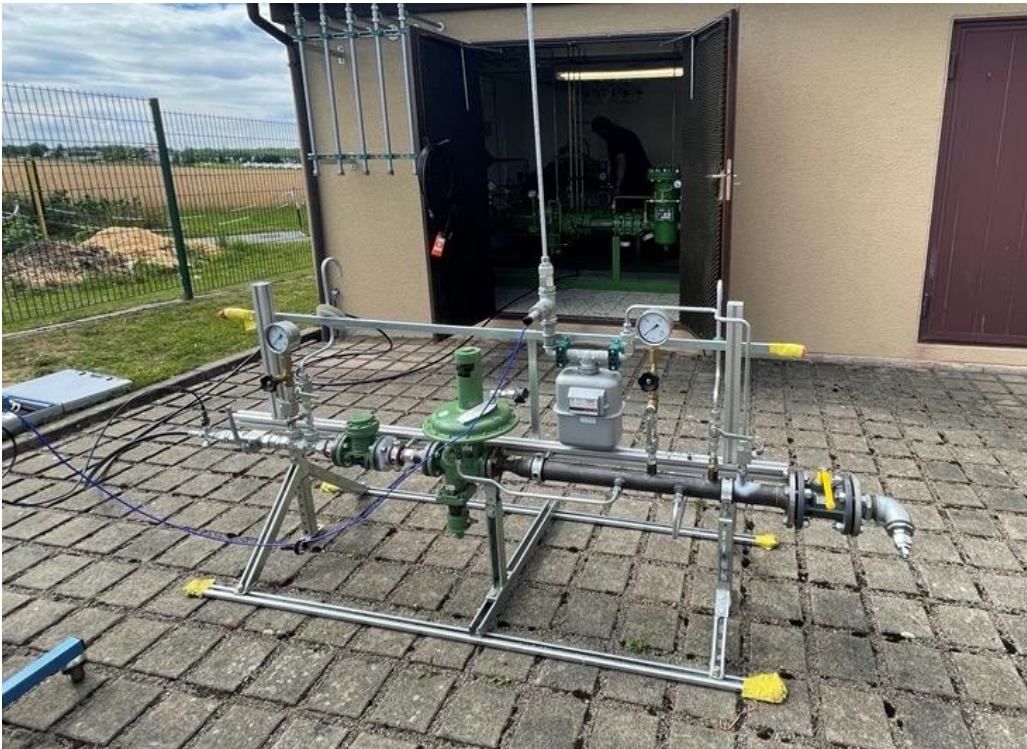
Abbildung 9: Aufbau der Regler-Messstrecke mit BGZ und Flügelrad
