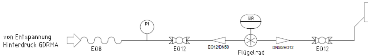
Abbildung 10: Skizze des Messaufbaus "Messrohr"
